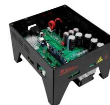
TI 电机驱动试验模块
